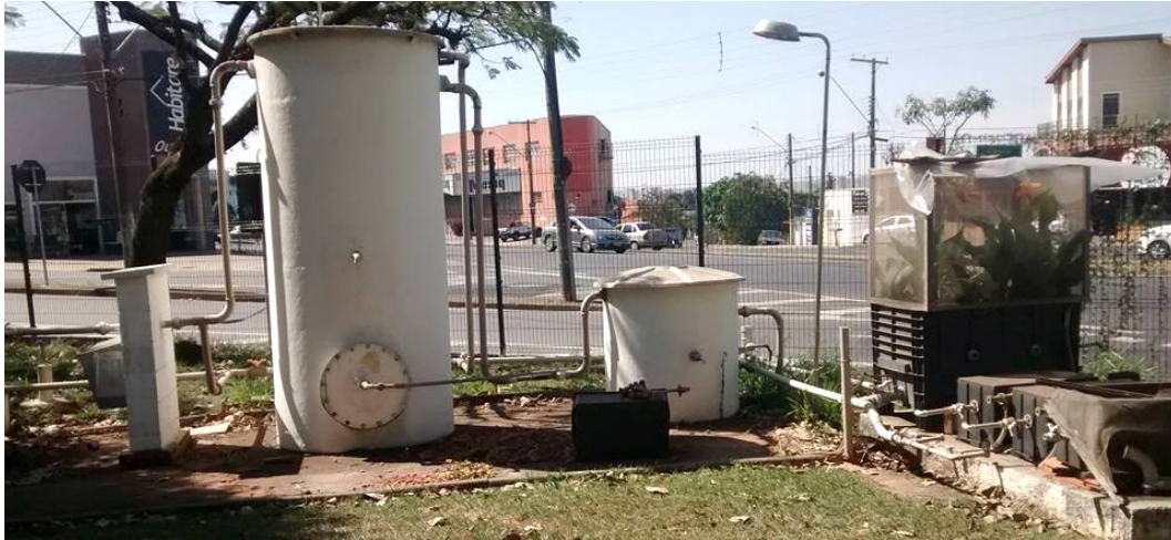
Figura 1 - ETE em escala piloto composto por UASB seguido de wetland da Faculdade de Tecnologia.
